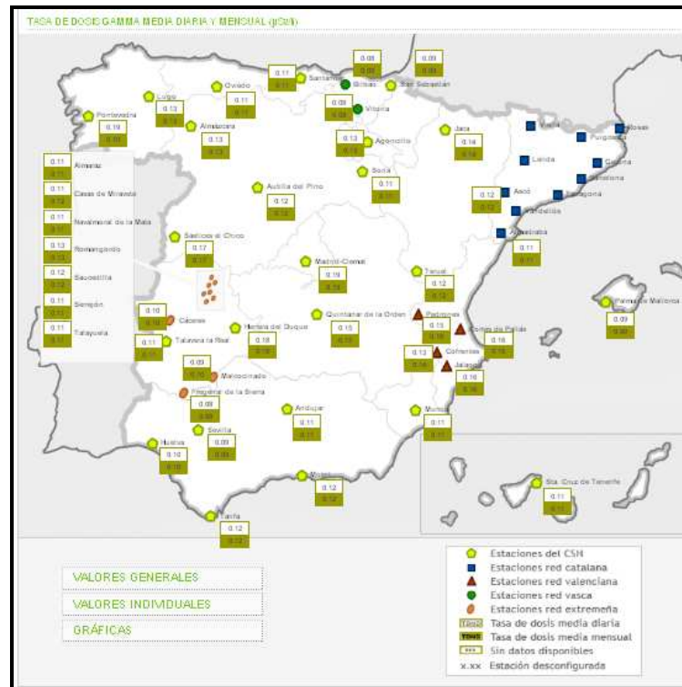
Figura 3.20. Exposición valores radioactivos en España: tasa de dosis media diaria y mensual. Fuente Consejo de Seguridad Nuclear (nd).
