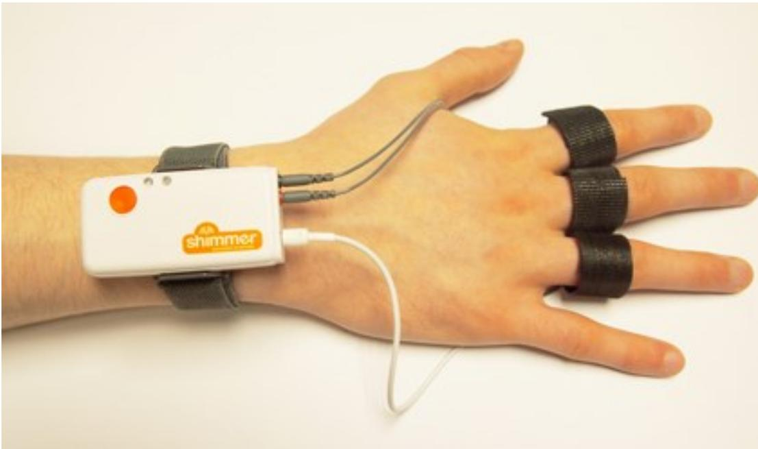
Ilustración 22 Dispositivo Shimmer para registro de actividad electrodérmicas. Fuente: Shimmer Sensing, 2020
