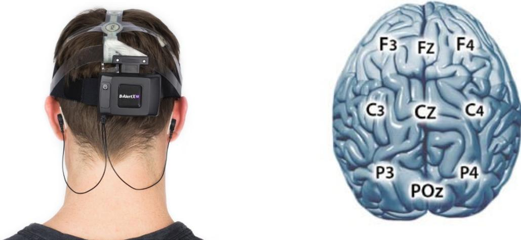
*Ilustración 23 Herramienta b-Alertx 10 para registro de señales EGG y colocación de los sensores. Fuente: iMotions, 2020*
