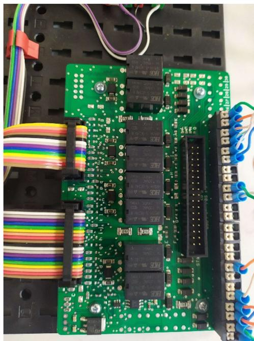
Figura 3. Relés y conexión de los bornes
