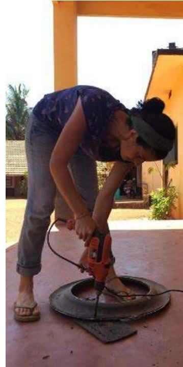
Ilustración 283: Taladrado de laterales de neumático. Fuente: propia
