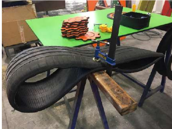
Ilustración 40: Taller de la empresa. Prueba de corte del neumático sin coronas interiores. Consejos de sujeción y seguridad. Fuente: propia
