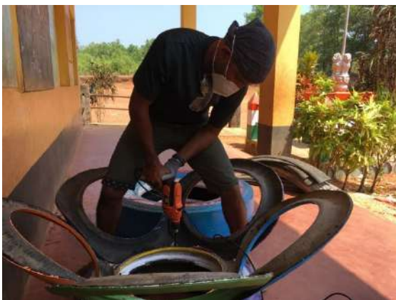
Ilustración 286: Proceso taladrado para unión de cuello y cabeza de Octopus. Fuente: propia
