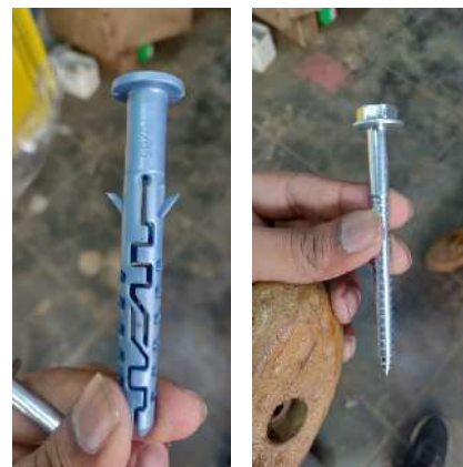
Ilustración 304: Tornillería para instalación de las presas de escalada. Fuente: propia
