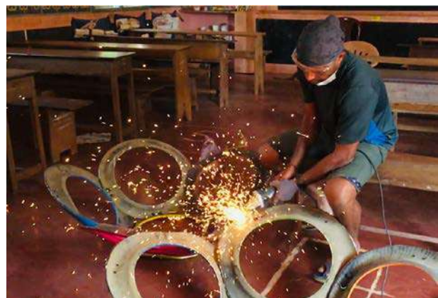
Ilustración 287: Proceso corte con radial de tornillos sobrantes. Fuente: propia
