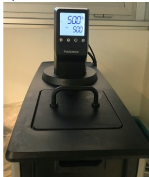
Figura 10. Baño de recirculación de agua Heildolph rotacool chiller a 50°C.
