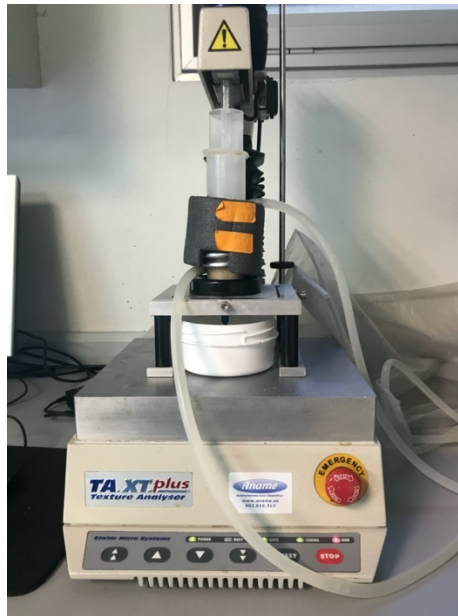
Figura 14. Texturómetro TA-XT Plus durante los análisis con la muestra.
