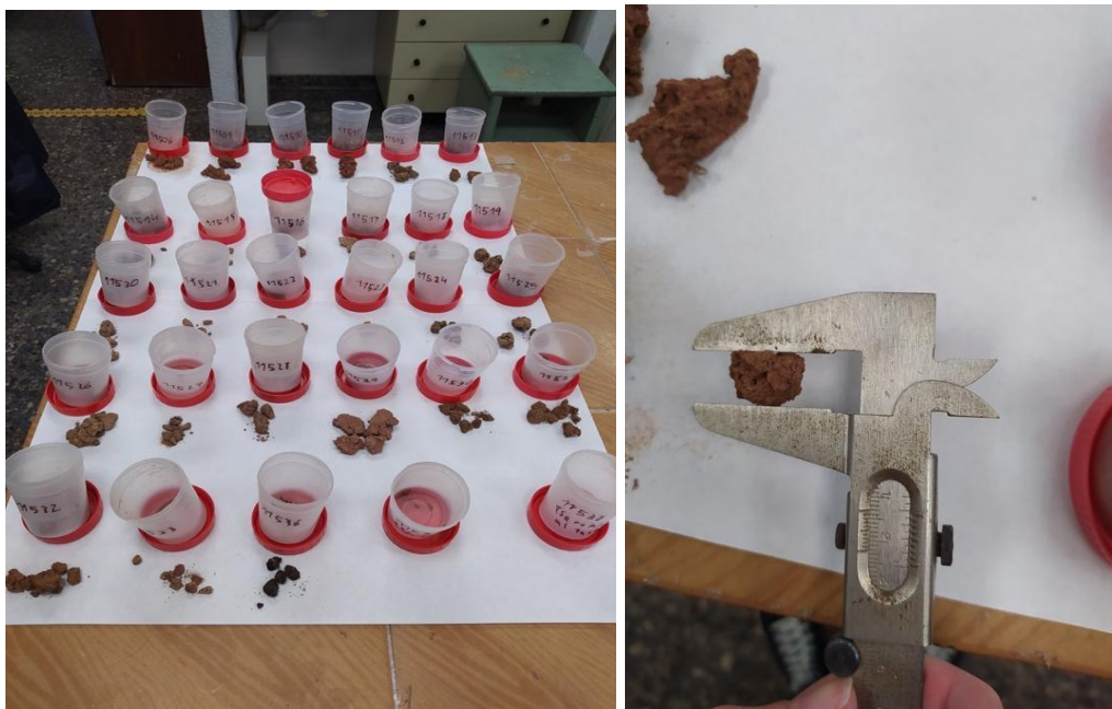
Figura 16: Agregados recogidos y detalle de la medición del tamaño mediante pie de rey
