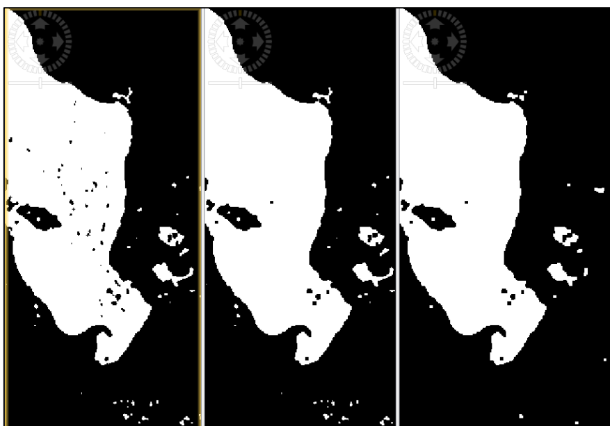
Figura 39. Zoom de la laguna de Gallocanta, método de clasificación. Filtros morfológicos. Sin filtro morfológico (Izquierda). Filtro de apertura (Centro). Filtro apertura y cerrado (Derecha)
