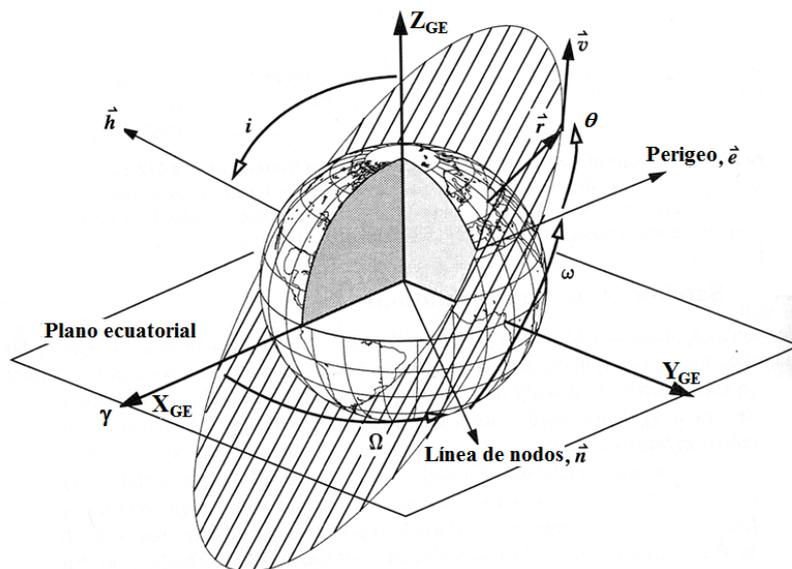
**Figura 8:** Para pasar las coordenadas del sistema perifocal al Geocéntrico-Ecuatorial habrá que hacer 3 giros a esas coordenadas.
