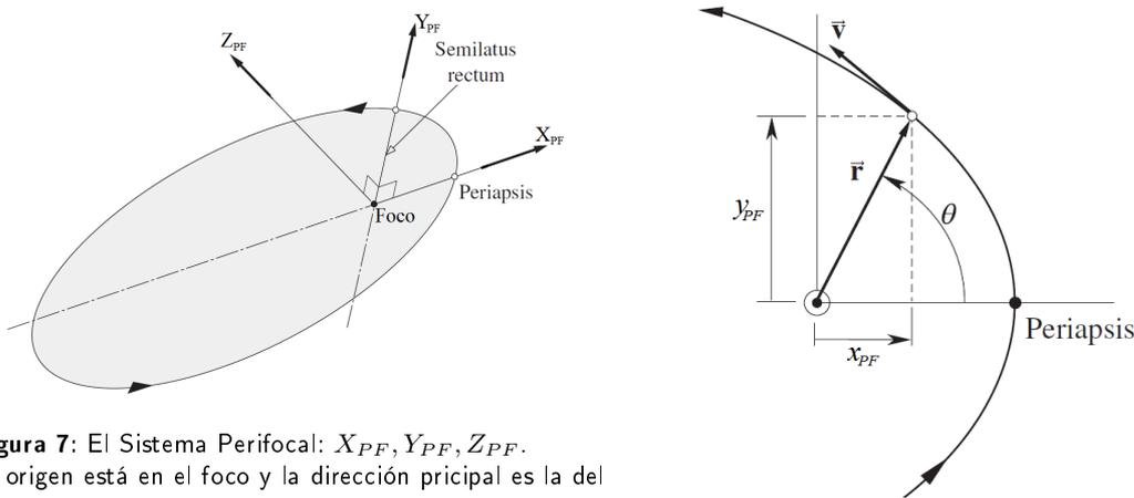
**Figura 7:** El Sistema Perifocal:  $X_{PF}, Y_{PF}, Z_{PF}$ . El origen está en el foco y la dirección principal es la del periapsis.
