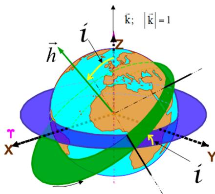
Figura 3:  $i$ : Ángulo entre el plano ecuatorial y el orbital.
