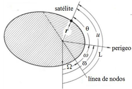
Figura 2: Elementos alternativos para órbitas circulares y/o ecuatoriales:  $\bar{\omega}$ ,  $u$  y  $L$
