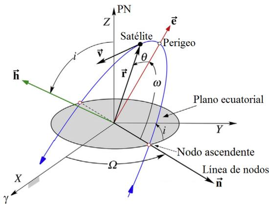
Figura 1: Elementos angulares de una órbita
