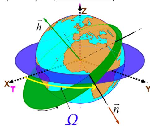
Figura 4:  $\Omega$ : Ángulo desde el Punto Vernal hasta la línea de nodos medido sobre el Ecuador.
