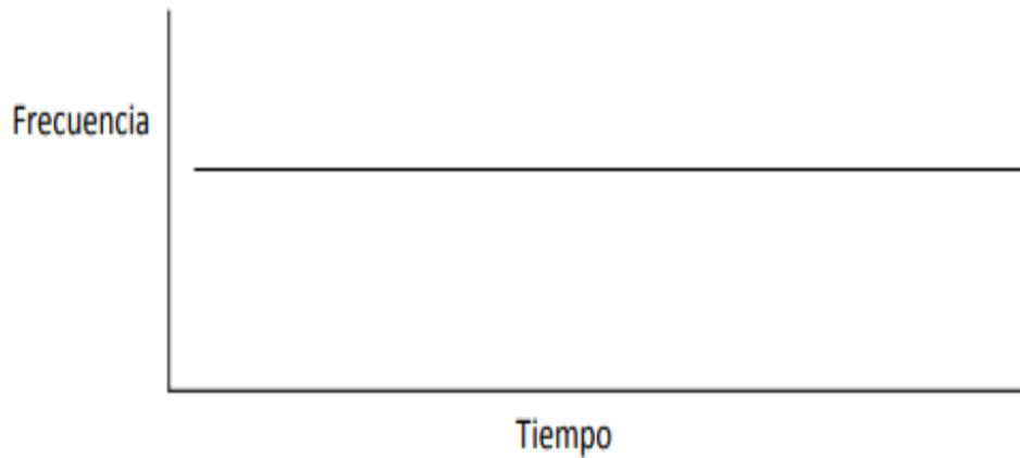
Figura 4. Espectrograma de una señal constante monocromática (señal tonal). Fuente: Chicote et al, 2013.
