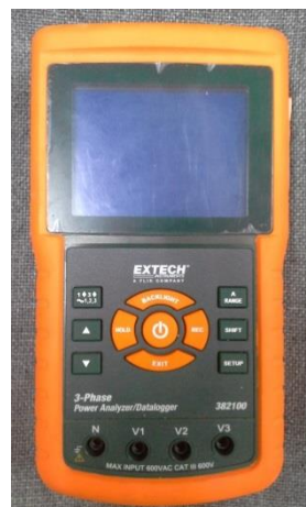
Figura 4.9.- Imagen del analizador/registrador utilizado para determinar el perfil de demanda.
