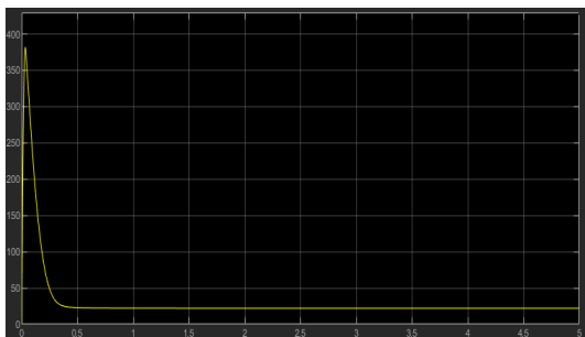
Figura 5.19: Módulo del fasor espacial de intensidad del estator ( A ).
