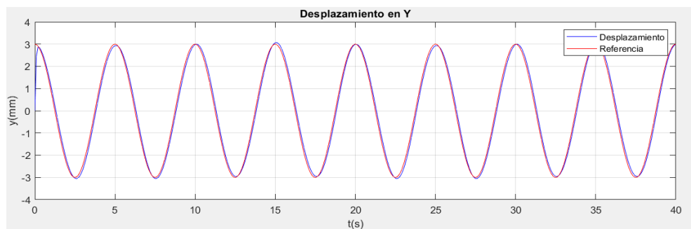
Figura 35. Desplazamiento de la plataforma en el eje Y vs tiempo
