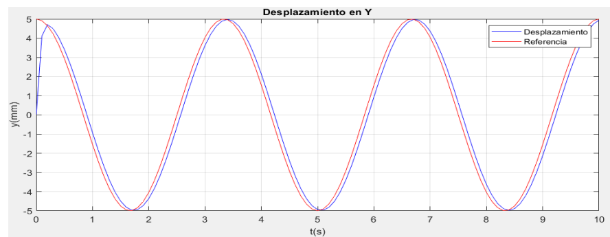
Figura 32. Desplazamiento de la plataforma en el eje Y vs tiempo
