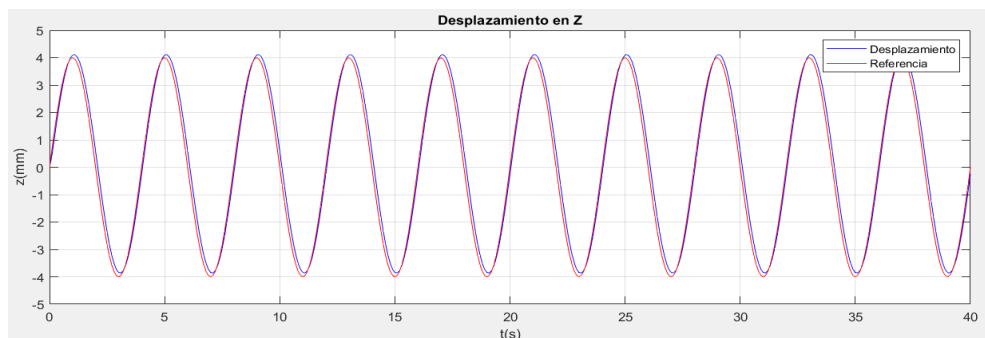
Figura 36. Desplazamiento de la plataforma en el eje Z vs tiempo
