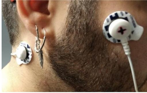
Figura 20. Posicionamiento sensor EMG y EDA.
