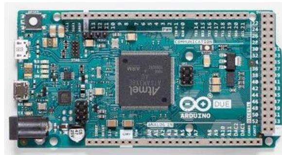
Figura 5. Placa Arduino DUE. Fuente: <https://store.arduino.cc/arduino-due>
