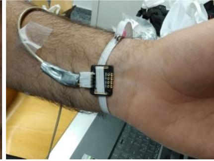
Figura 21. Posicionamiento sensor SpO2.
