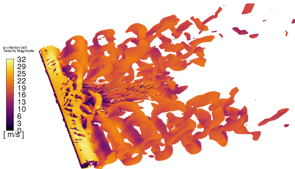
Figura 4.22: Isosuperficie de Q\text{-criterion} = 2 \cdot 10^5 coloreada según la magnitud de la velocidad en el dominio.
