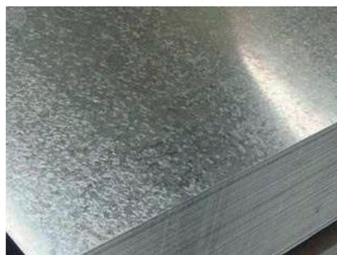
Figura 45. Chapa de acero galvanizado
