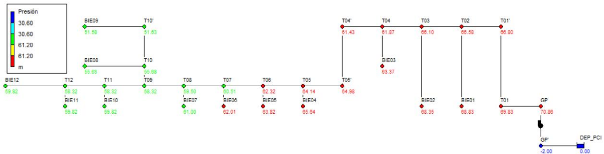
Ilustración 15: Epanet – Red BIEs– Simulación más desfavorable - Presiones.
