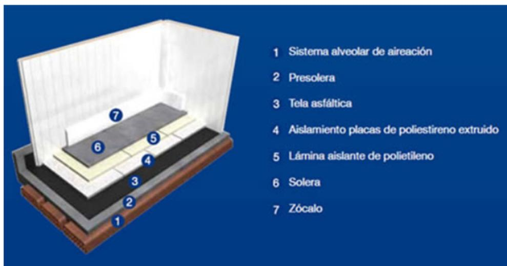
**Figura 2.** Descomposición del suelo a instalar.
