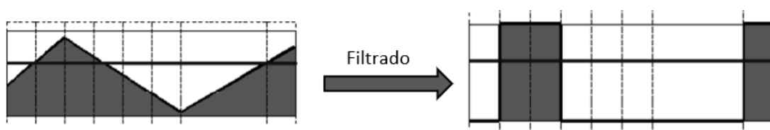
Ilustración 2.3 - Explicación gráfica de filtro Threshold Binary
