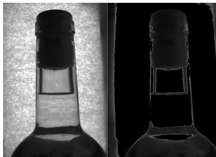
Ilustración 2.2 - Resultado de aplicar filtro Thresholding
