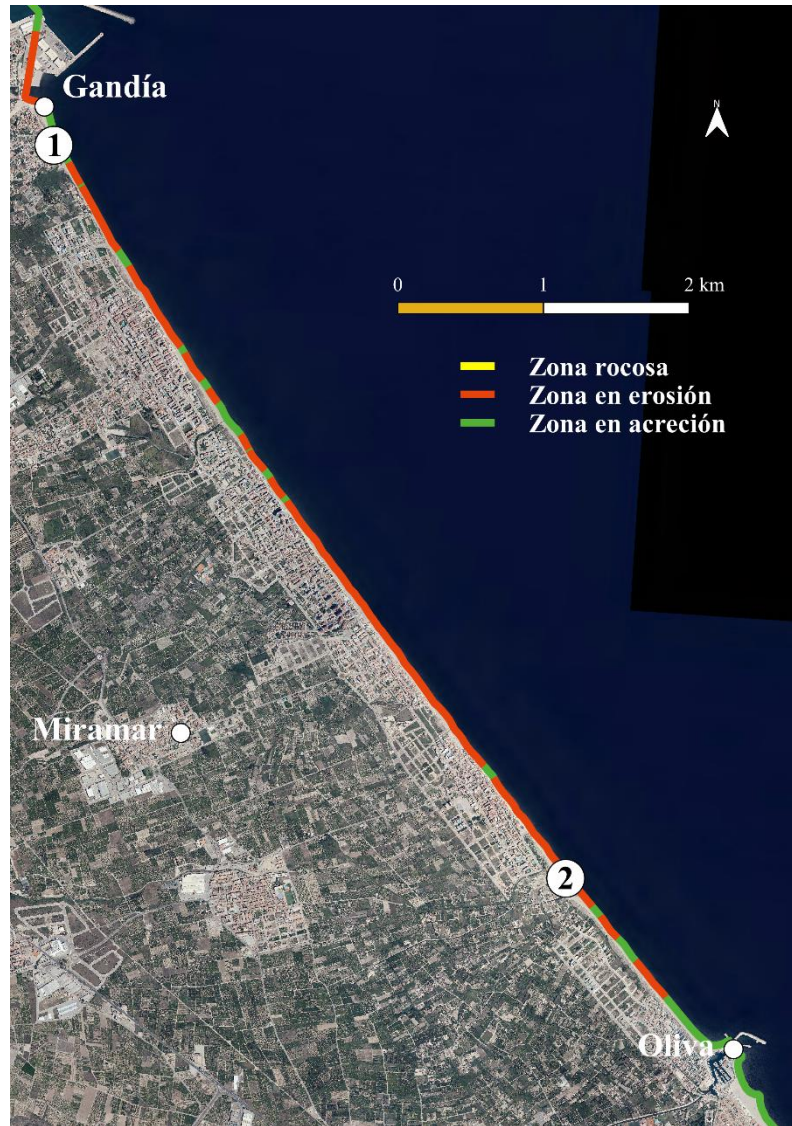
Figura 117. Zonificación del Tramo 8. Fuente: PNOA (2020).
