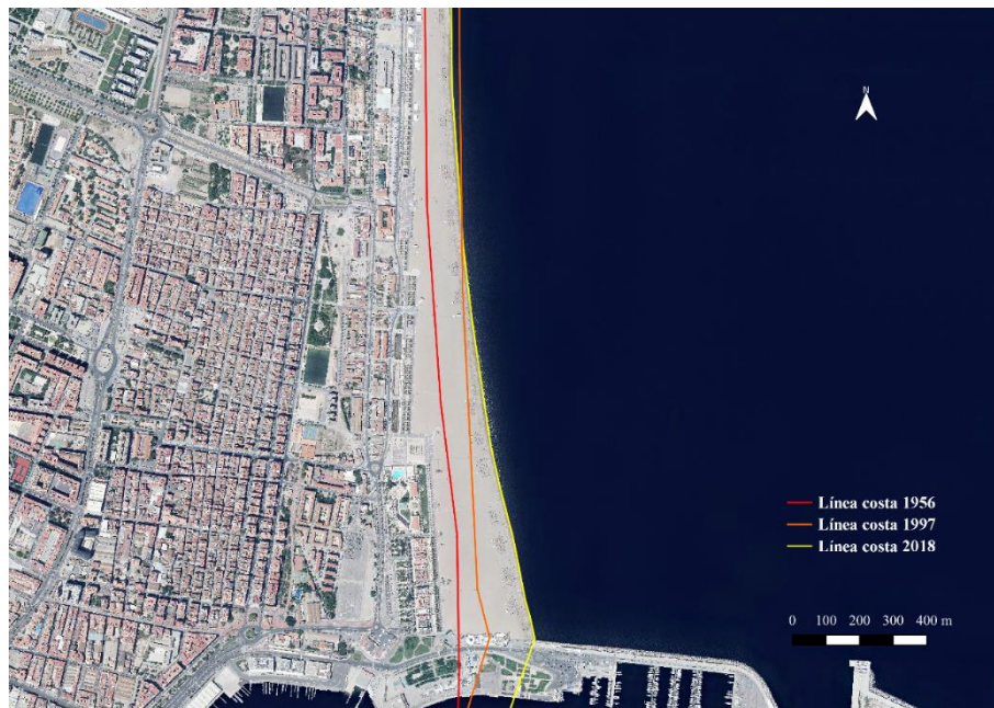
Figura 34. Evolución de la línea de costa en la playa de La Malvarrosa (Valencia).
