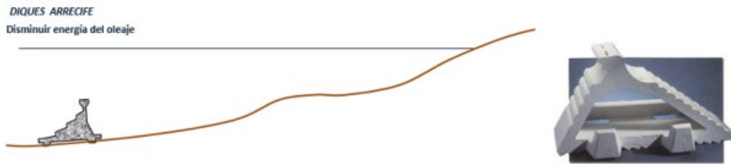
Ilustración 73: Diques arrecife. Fuente: Asignatura Obras marítimas.
