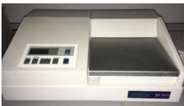
Ilustración 4. Imagen con el código del test y su intervalo de aplicación (test de 100 muestras) (imagen superior) y espectrofotómetro Spectroquant® usado para la medición de la concentración de nitratos (imagen inferior).
