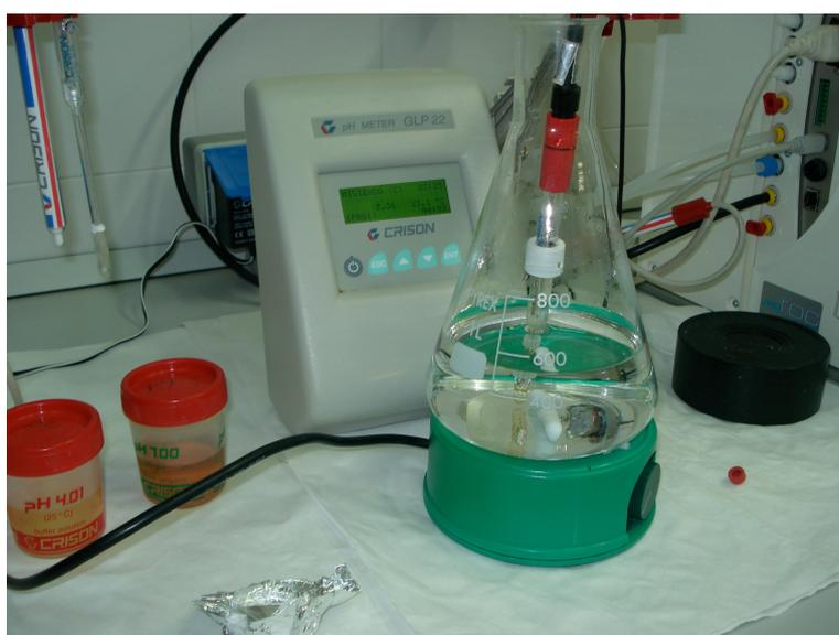
Figura 5. pHmetro (pH METER GLP 22) para controlar el pH de los medios de dilución y cultivo empleados en los experimentos.
