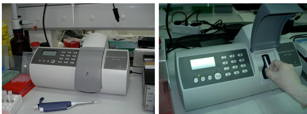
Figura 16. Contador de núcleos espermáticos para valorar la concentración espermática.
