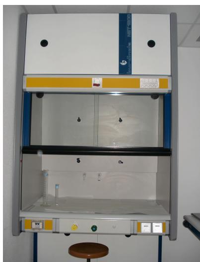
Figura 8. Campana de gases NST 1200, Burdinola empleada para preparar las soluciones de trabajo para la cuantificación de Malondialdehído (MDA).
