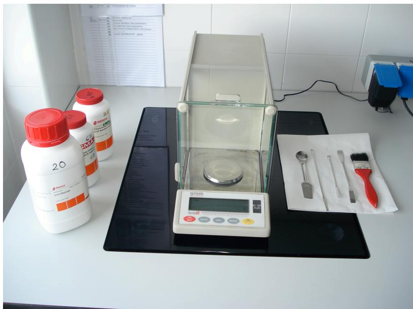
Figura 4. Balanza analítica de precisión utilizada para el pesaje de los diferentes componentes de los medios de dilución y cultivo empleados experimentos.
