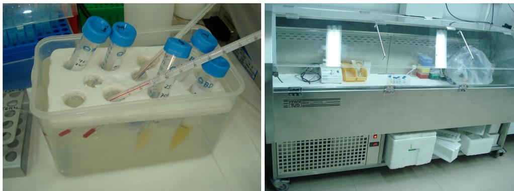
Figura 11. Recipiente con agua para el descenso gradual de temperatura y vitrina térmica a 5 °C.
