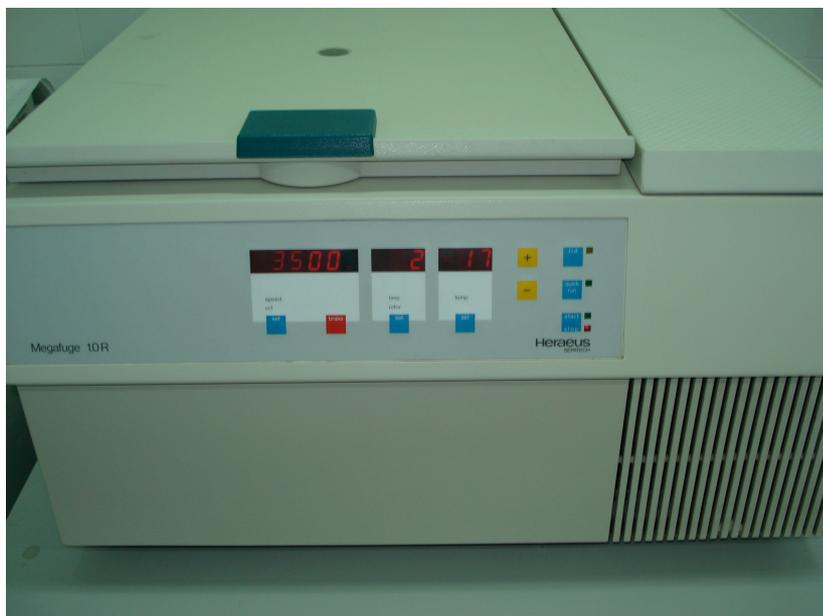
Figura 9. Centrifuga Megafuge 1.0R refrigerada a 17 °C empleada para concentrar el pellet de espermatozoides antes de iniciar el proceso de criopreservación.
