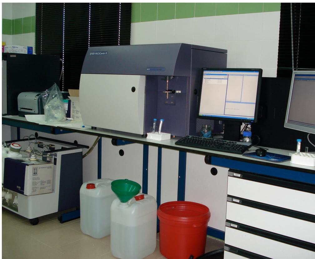
Figura 21. Citómetro de flujo (BD FACS Canto II™) empleado para los análisis de citometría.
