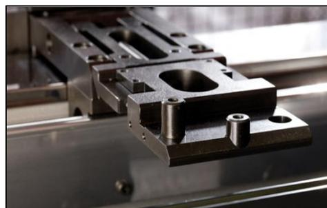
*Tope trasero de la bancada, marca la profundidad del pliegue.*
