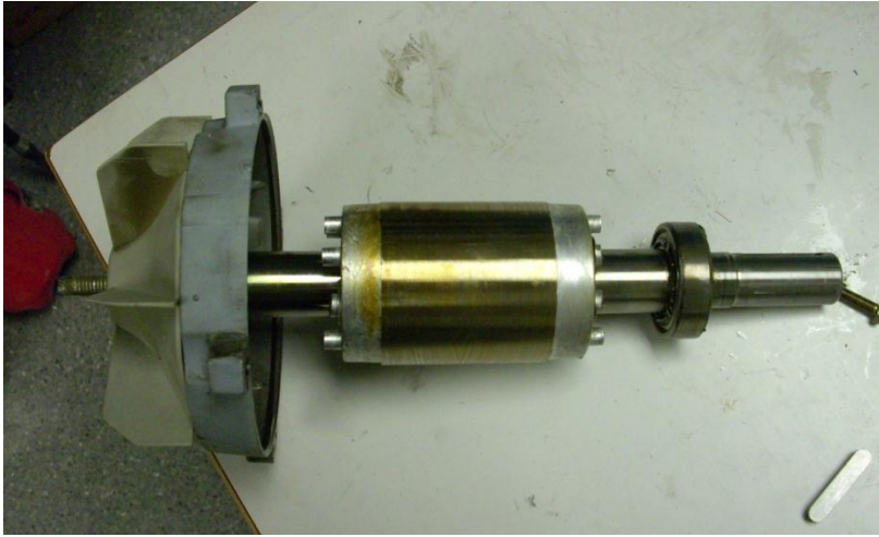
Fig. 122 Estado del rotor previo al mecanizado
