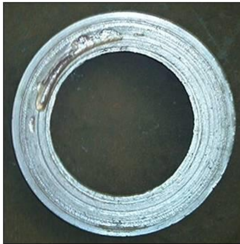
Fig. 6 Sección de un anillo de cortocircuito mostrando inclusiones gaseosas
