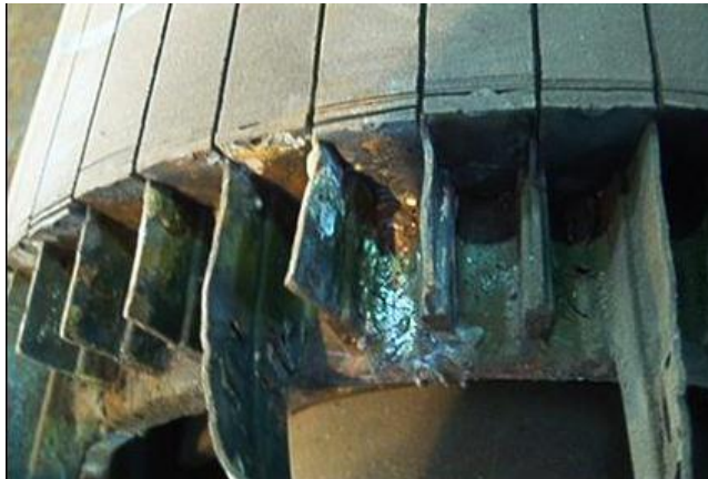
Fig. 7 Típico fallo de un anillo de cortocircuito manufacturado mediante el método rolled ring .
