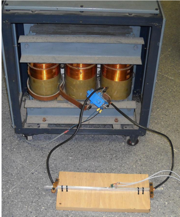
Fig. 192 Calibración del sensor CSA-1V
