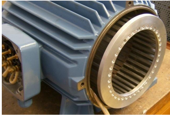
Fig. 184 Estátor del motor de inducción invertido.
