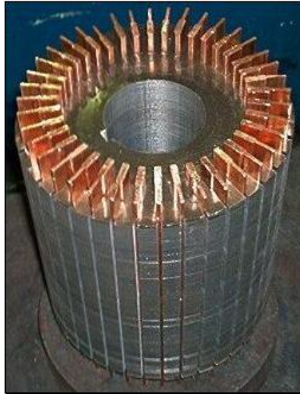
Fig. 3 Barras de cobre insertadas en la armadura de un rotor
