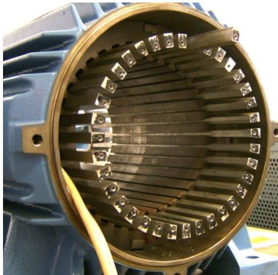
Fig. 183 Barras introducidas en los huecos del estátor.
