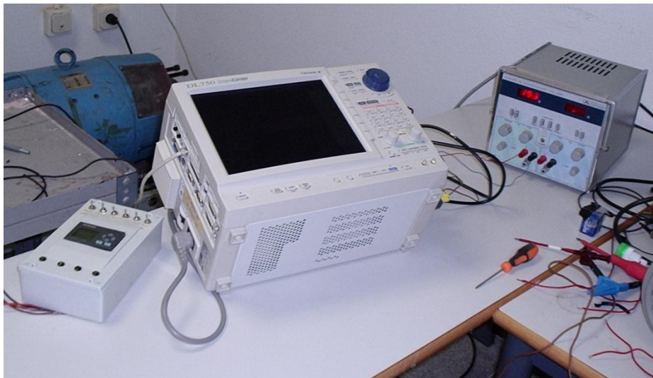
Fig. 179 Autómata de control, registrator Yokogawa y fuente de alimentación del acelerómetro y del encoder .
