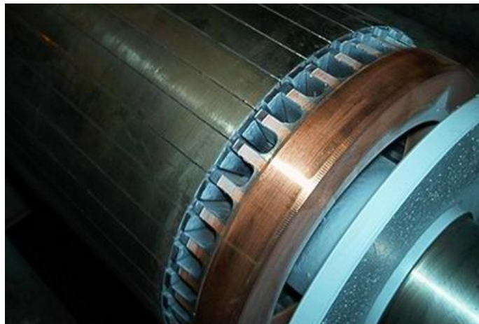
Fig. 4 Barras de cobre soldadas mediante el método side bar
