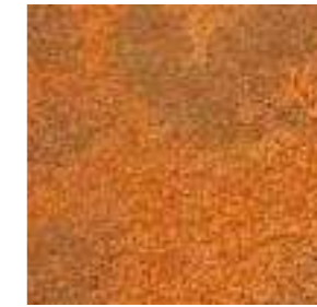
4 Acero corten utilizado en muros, puertas exteriores, vierteaguas o remates de antepecho
