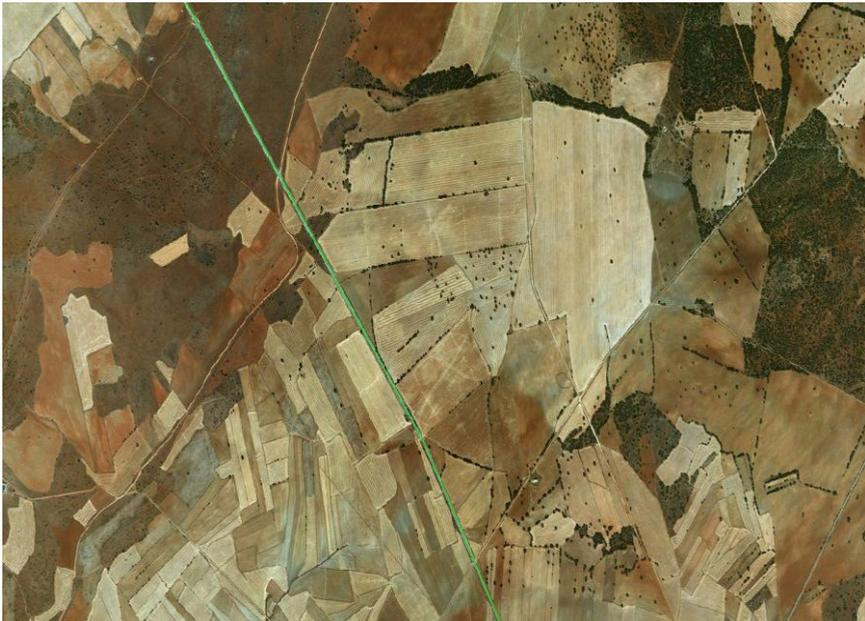
**Figura XXIV: Ejemplo. Marcado inicial de puntos de una curva de bajo ángulo de deflexión Imagen de ortofotografías aéreas del servicio online de libre distribución (PNOA)**
