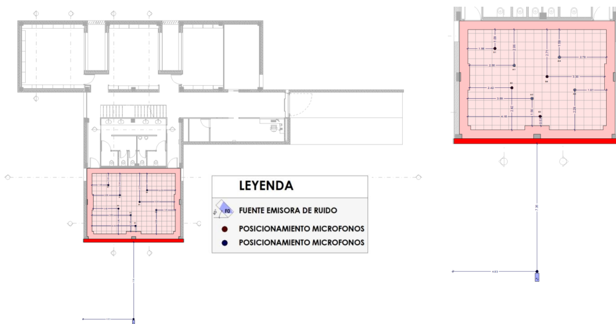
Figura 35_ Plano medición “in situ” Ruido de impacto y plano detalle zonas recepción ruido , locales receptores (color rojo)
