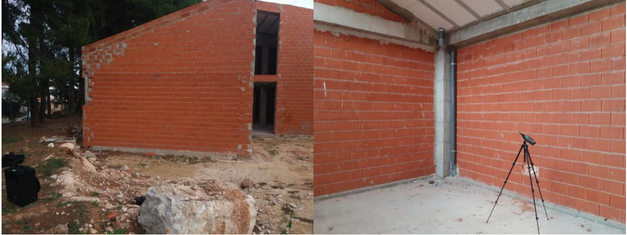
Figura 31_ Medición acústica en fase de ejecución
