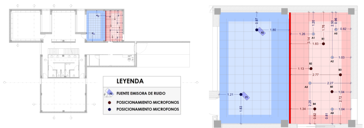
Figura 32_ Plano medición “in situ” asilamiento acústico ruido aéreo
