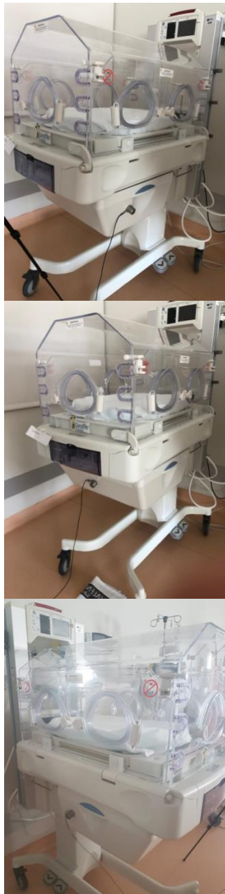
Figura 11 - Niveles de aceleración registrados para el cajón de la incubadora (posiciones 4, 5 y 6).
