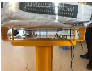
Figura 30 - Niveles de aceleración registrados para el eje de la cuna neonatal (posiciones 4, 5 y 6).
