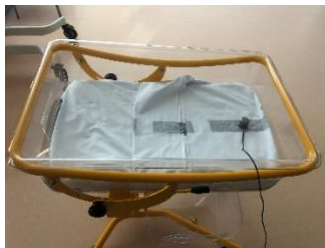
Figura 32 - Niveles de aceleración registrados sobre el colchón de la cuna neonatal (posiciones 10, 11 y 12).
