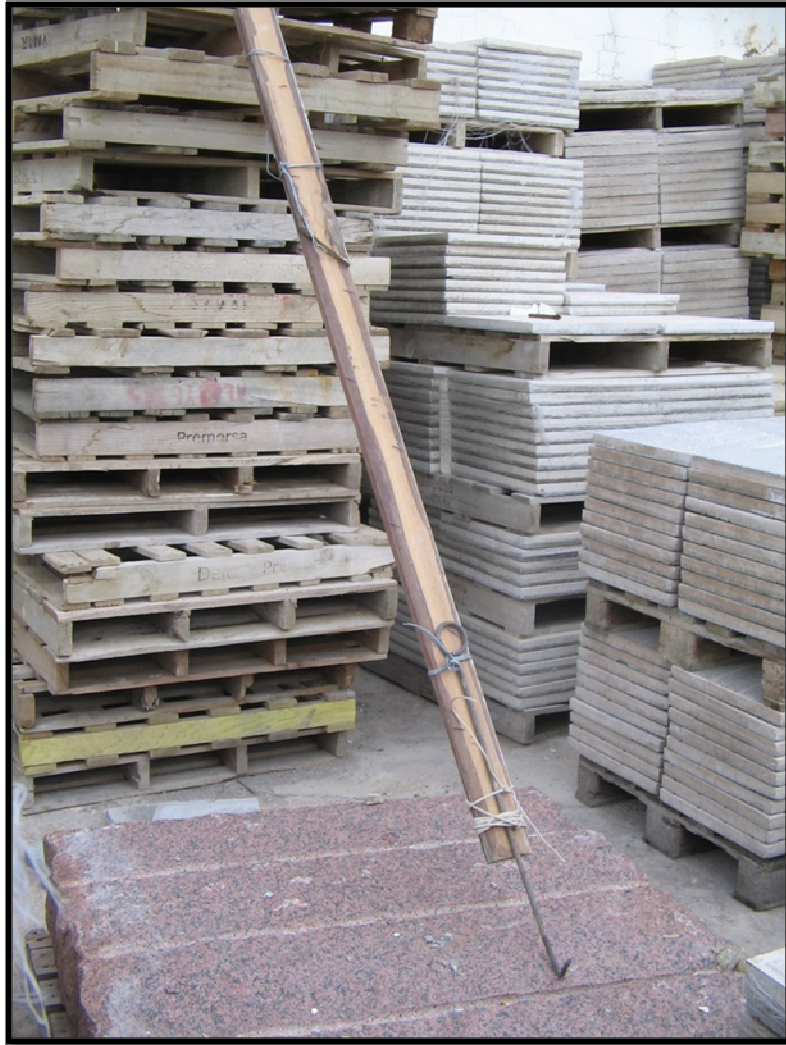
Fotografía 3. Pértiga utilizada en el cuarto robo para la desconexión de media tensión.
