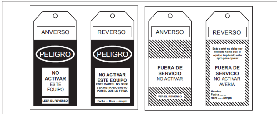
Figura 5. Ejemplos de carteles que pueden colocarse sobre los dispositivos de maniobra para que no sean accionados.
