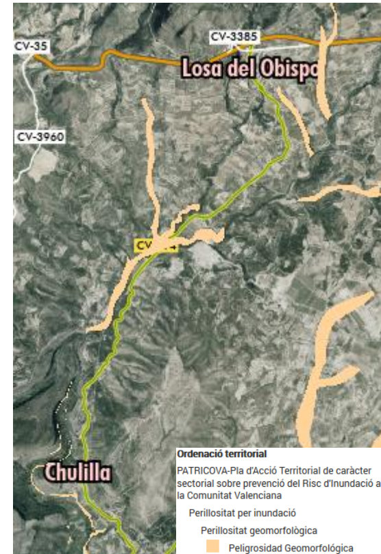
Figura 54: Peligrosidad geomorfológica de inundación (PATRICOVA).
