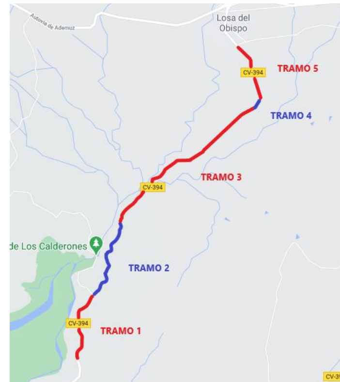
Figura 14: Tramos que cumplen el ancho mínimo de carril (color azul) y los que incumplen (color rojo). Fuente: Elaboración propia
