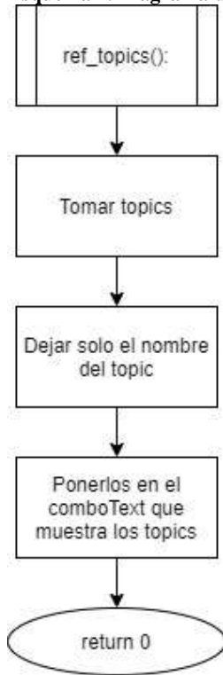
Esquema 7. Diagrama de flujo de la función ref_topics()
