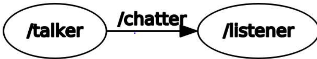
Figura 2. Digrama de interconexión de los nodos /talker y /listener
