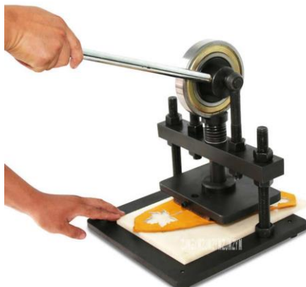
Figura 37: máquina troqueladora manual utilizada por operario.
