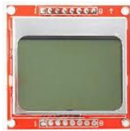
Figura 8: Pantalla Nokia LCD 5110 con 8 pines de entradas y salidas y 84x48 pixeles.
