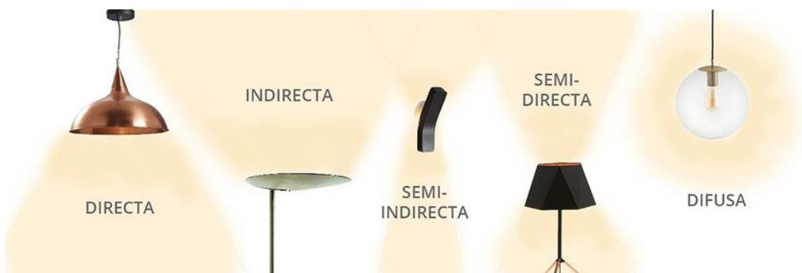
Fig. 4 Tipos de iluminación según el flujo de luz
