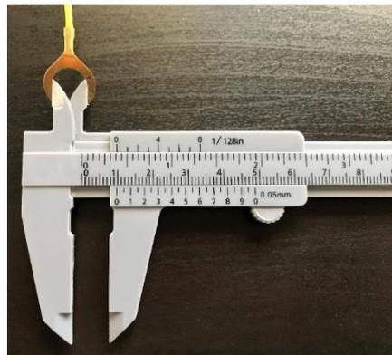
Fig. 84 Diámetro del terminal del cable amarillo
