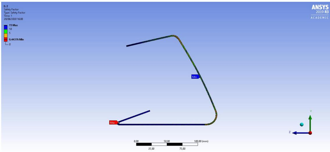
Fig. 67 Factor de seguridad en chapa de acero inoxidable de 2 mm de espesor
