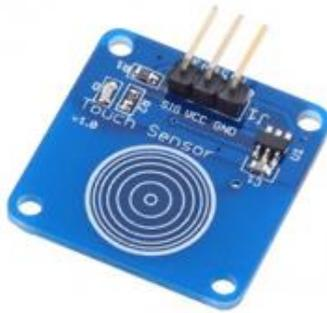
Fig. 8 Interruptor táctil de bajo voltaje
