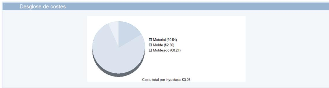
Fig. 52 Costes de fabricación del elemento 1.2
