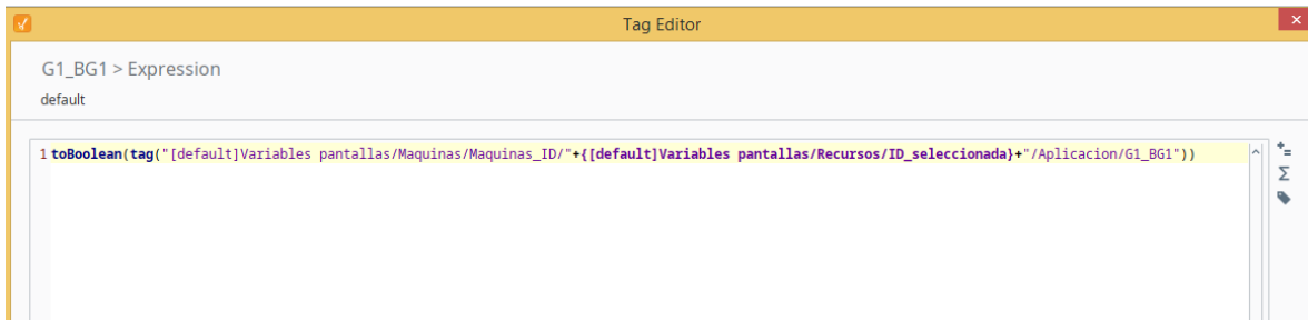
Ilustración 33 Ejemplo programación variable en función de máquina seleccionada.
