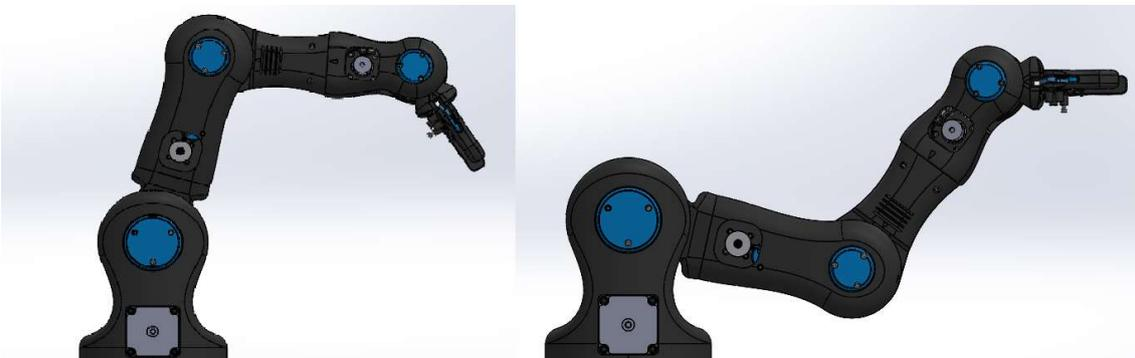
Ilustración 7. A la izquierda se muestra la configuración del robot BCN3D MOVEO con una configuración de codo arriba y a la derecha se observa la configuración codo hacia abajo.
