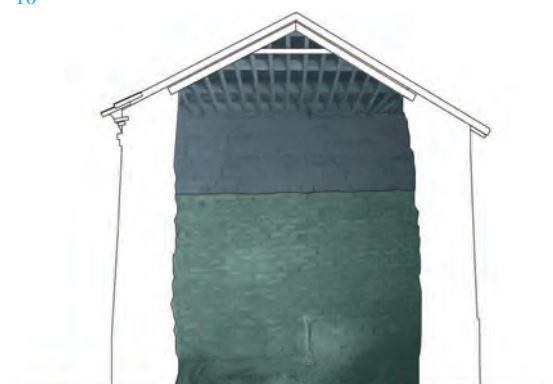
10 1m 2m 5m Periodo 2 (posterior a la intervención) ADOBES 40x20x10 Periodo 1 (anterior a la intervención) ADOBES 60x30x10
