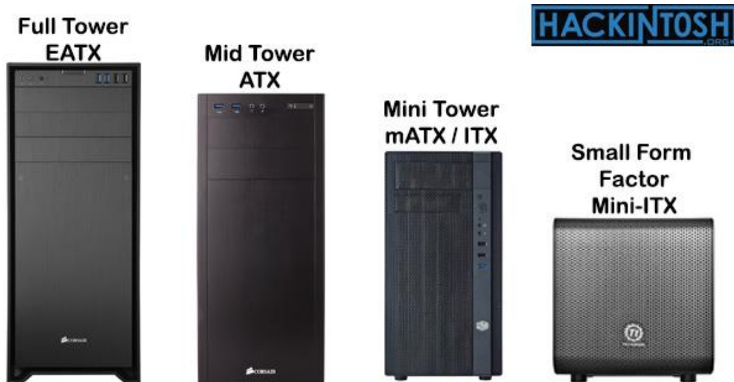
Figura 4: Clasificación de gabinetes de ordenador según sus dimensiones
