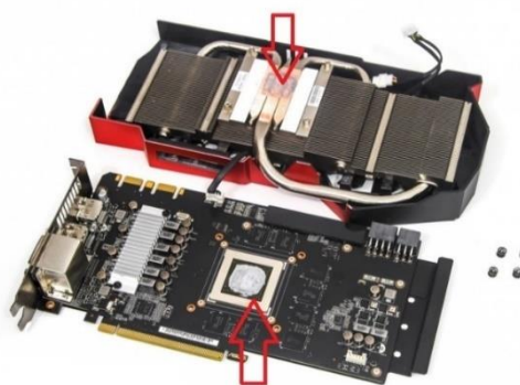
Figura 7: Disipador GPU (Arriba) PCB (Abajo) con zona de contacto marcada
