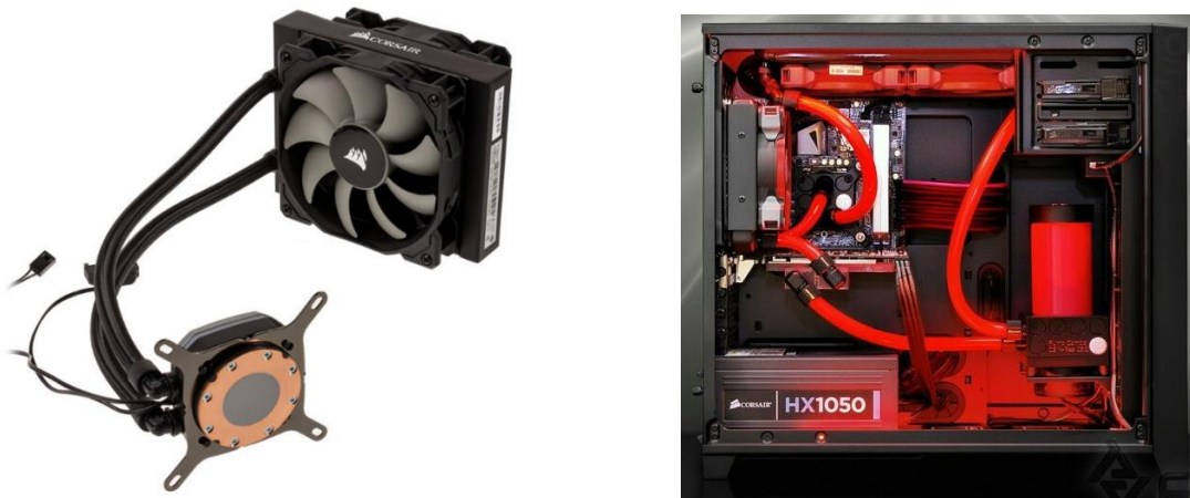
Figura 9: Refrigeración líquida AIO (izquierda) y refrigeración líquida personalizada (derecha)
