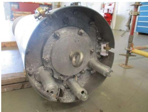
Figura 20. Parte superior de la bomba 21-P-04B
