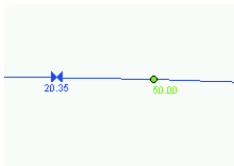
Figura 29, Válvula reductora de la instalación.
