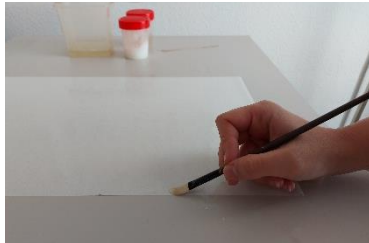
Ilustración 32. Proceso de aplicación del adhesivo en el perímetro de una lámina para una adhesión perimetral.
