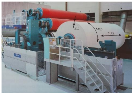
Ilustración 21. Papel en rollo en la sección de bobinado de una máquina de papel. La dirección de la máquina (MD) está alineada en paralelo con el movimiento de la banda a través de la máquina de papel. La dirección transversal (CD) está alineada en paralelo al carrete de cuerda. La dirección fuera del plano (ZD) es perpendicular al plano principal de la red formada por los vectores MD y CD.
