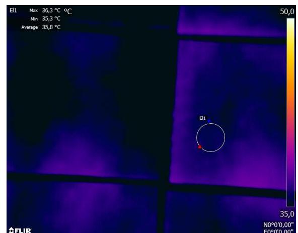
Imagen 41. Medición con ajuste de histograma de temperaturas entre 35-50°C, correspondiente al punto MC3-C, con señalización de valores de temperatura característicos de la imagen. Elaboración propia mediante el programa FLIRTools.
