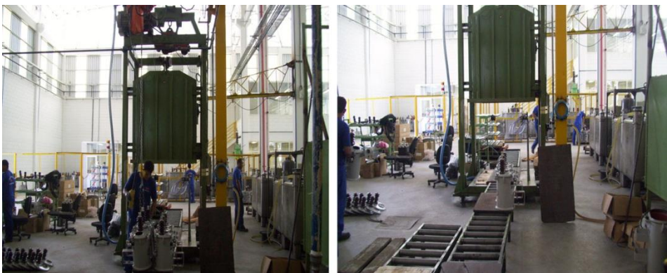
Figura 32. Camara para llenar el transformador con aceite
