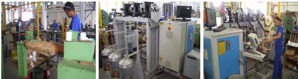
Figura 26. Proceso bobinar: mecánico y automático
