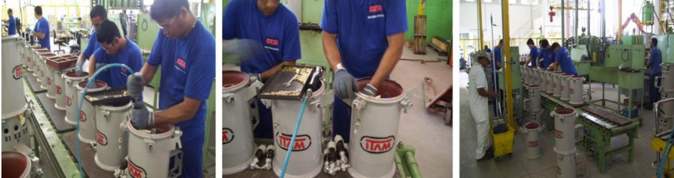
Figura 29. Montaje de la parte activa en el tanque
