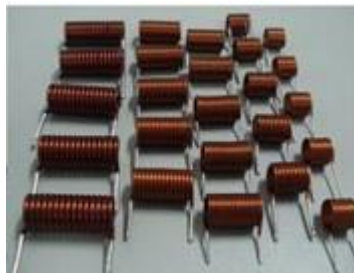
Figura 6. Inductores de filtro de aire
