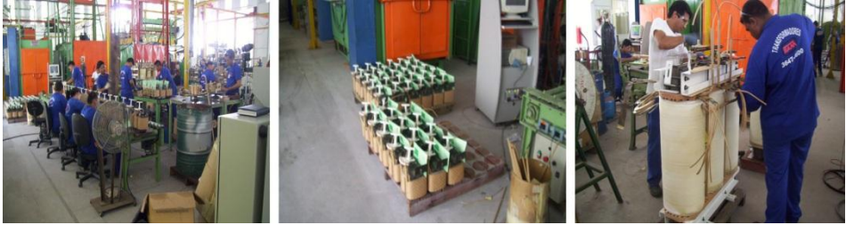
Figura 27. Montaje de la parte activa Fuente: Autor
