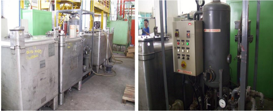
Figura 31. Proceso de calentar el aceite
