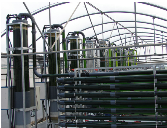
Figura 3: Fotobiorreactor cerrado tipo tubular para la producción de microalgas.
