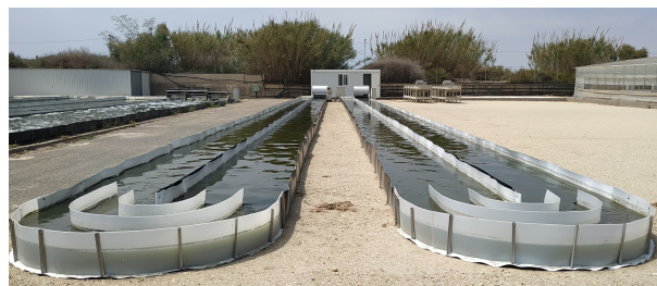
Figura 2: Fotobiorreactor abierto o raceway para la producción de microalgas.
