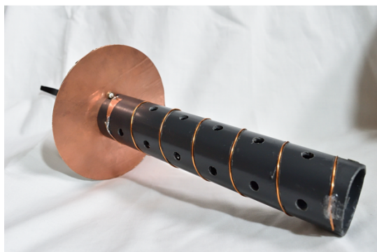
Figura 5. Ejemplos de antenas fabricadas por los estudiantes a partir de materiales reciclados.
