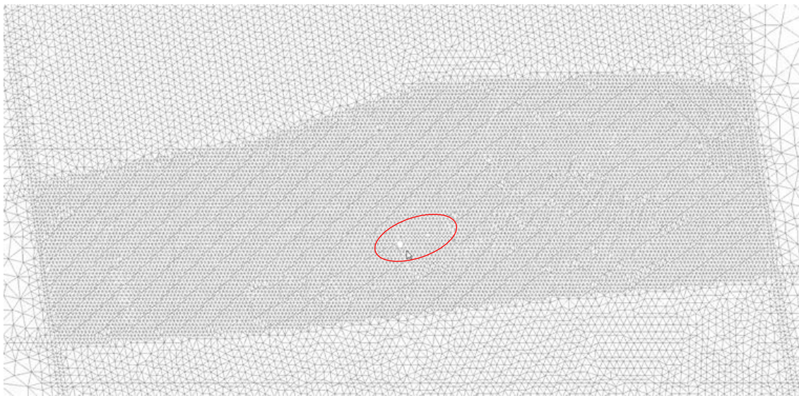
Imagen 22: Detalle pilas de la malla (Fuente: Iber)
