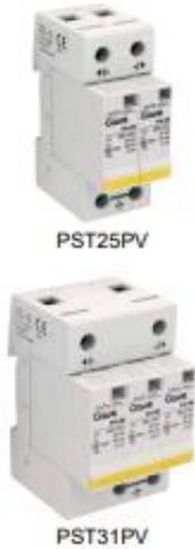
Las protecciones de Clase II se destinan a la protección de las redes de alimentación fotovoltaica contra las sobretensiones transitorias debidas a descargas atmosféricas. Los productos se instalan en paralelo en las redes a proteger y ofrecen una protección en modo común o modo común y diferencial. El esquema eléctrico integra varistores con un sistema de desconexión y sus indicadores asociados.
