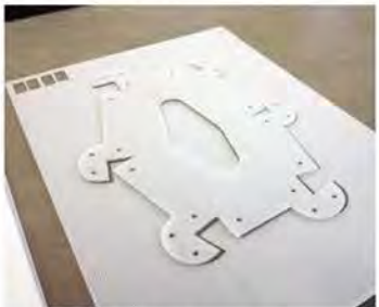
Pieza del Shellstar y sus uniones.
