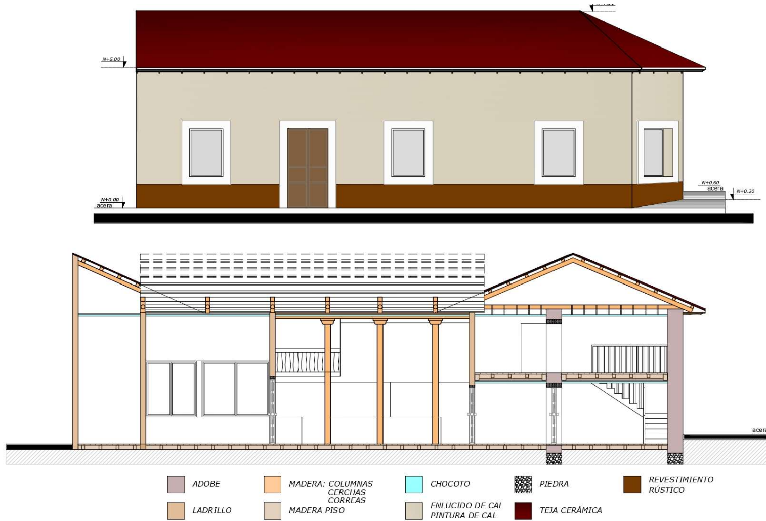
Imagen 30: Materialidad en fachada (sup.) y Vista en sección de materiales (inf.). Fuente: Elaboración propia
