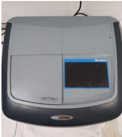
**Figura 13. Espectrofotómetro DR6000 de HACH**
