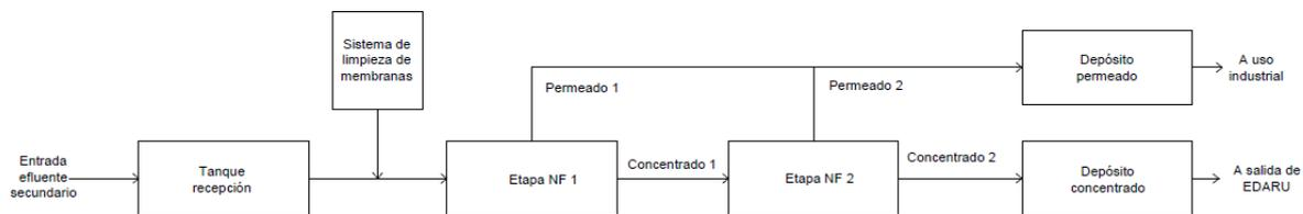
Figura 32. Esquema planta NF diseñada
