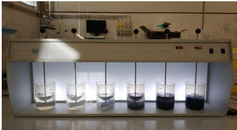
**Figura 8. Equipo de Jar-Test de la marca VELP Scientifica modelo JLT 6**
