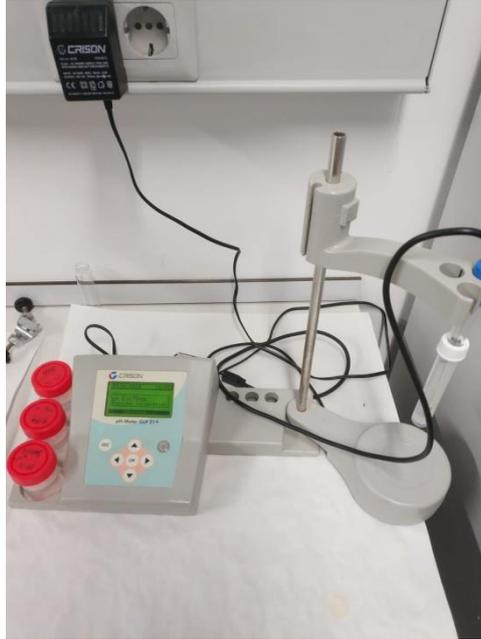
**Figura 18. Medidor de pH GLP 21+ de Crison**
