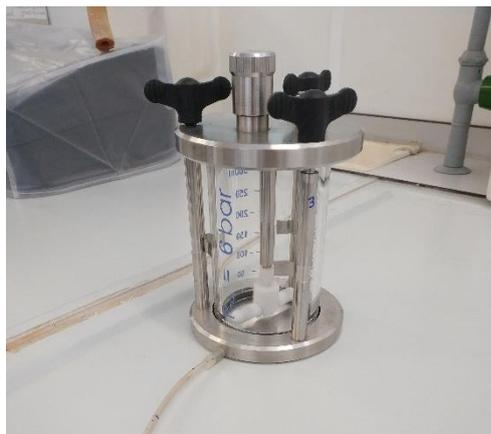
**Figura 9. Módulo de membranas Millipore de 300 mL**
