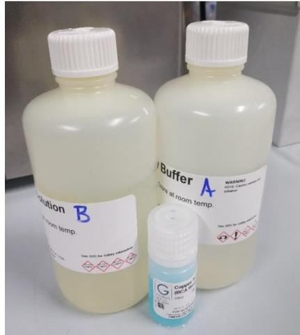
**Figura 14. Reactivos A, B y C (azul) para el método micro BCA**
